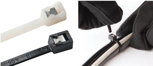
Der selbstschneidende Kabelbinder nVent CADDY ist eine vielseitige, werkzeuglose Datenkommunikationslösung zum Bündeln vieler Kabel. Dieses einfache, aber innovative Produkt verfügt über ein integriertes Schneidmesser für eine sichere Befestigung sowie ein sicheres und sauberes Abtrennen. Der selbstschneidende Kabelbinder aus strapazierfähigem Nylon vom Typ 6/6 verfügt über eine robuste Zugfestigkeit von 50 lb/22 kg.
