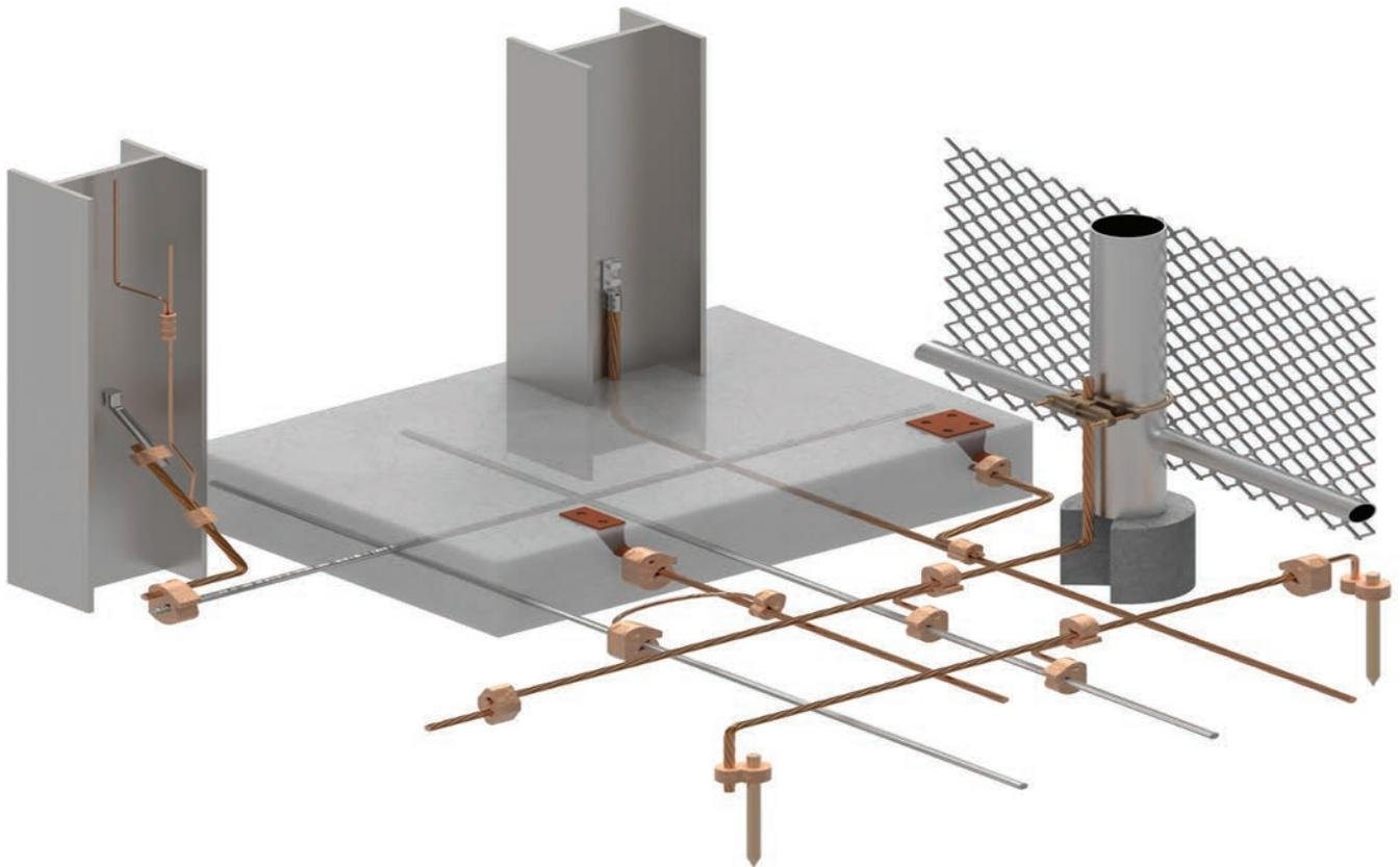
**I connettori di messa a terra a compressione nVent ERICO costituiscono una linea completa di connettori di compressione estrusi in rame di alta qualità per tutte le applicazioni di messa a terra.**
