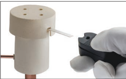
Fig. 12 – Coloque la tira de encendido en el conector de la unidad de control. Elimine o proteja los riesgos de incendio cerca de la conexión. Informe al personal cercano de las operaciones de soldadura a realizar en la zona.
