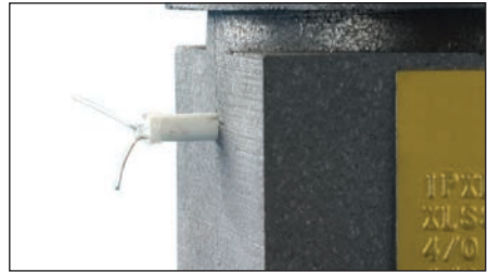
Fig. 23 – A continuación, coja una espiga de encendido y colóquela hasta la mitad en el pequeño orificio del lado del molde, con el lado del bucle orientado hacia el orificio. Separe los cables.
