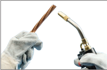
Fig. 11 – Los conductores deben estar limpios y secos antes de realizar la conexión. Use un soplete para quitar la humedad de los conductores y elimine los residuos de limpieza restantes, disolvente o agua antes de realizar la conexión Cadweld.
