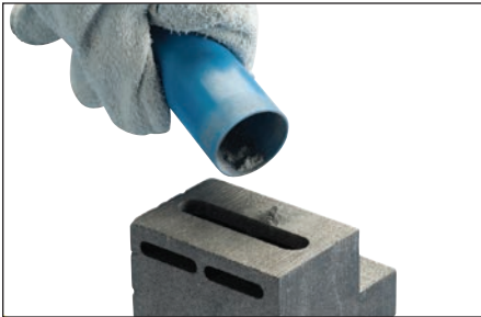
Fig. 23 – Cierre la tapa y vierta los 3/4 a 2/3 restantes del material de ignición en la ranura de la cubierta del molde.
