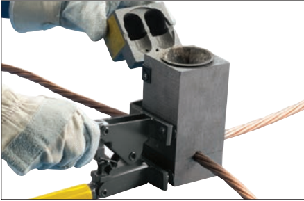
Fig. 21 – Retire el conector de la unidad de control de la tira de encendido. Abra la tapa y retire del molde crisol Cadweld Plus utilizado.
