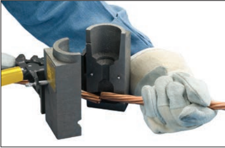
Fig. 15 – Inserte los conductores y póngalos en posición para la conexión.
