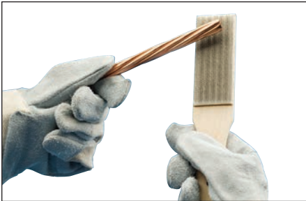
Fig. 12 – A continuación, utilice un cepillo metálico para preparar la superficie de los conductores y pica de puesta a tierra (cepillo nVent ERICO T-313 o T-314). Raspe la superficie exterior para eliminar la suciedad y la oxidación. Notará un ligero cambio de color.
