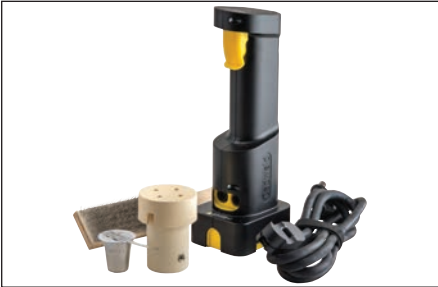
Fig. 2 – Prepare los materiales y el equipo adecuados para el tipo de conexión que está realizando. El sistema Cadweld Plus One Shot requiere un molde cerámico Cadweld One Shot, metal de aporte Cadweld Plus, cepillo metálico para limpiar/preparar conductores, Unidad de Control de Soldadura aluminotérmica nVent ERICO Cadweld Plus Impulse y soplete.
