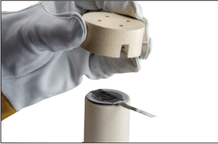
Fig. 10 – Coloque la tapa de cerámica sobre el molde.
