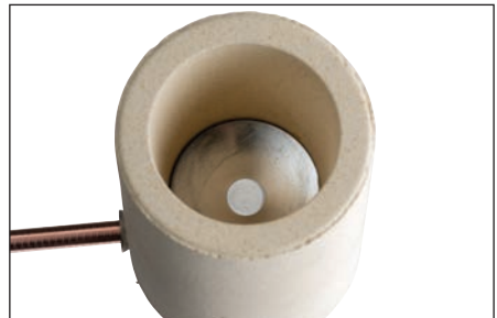
Fig. 9 – Asegúrese que el disco esté posicionado correctamente dentro del Cadweld One Shot.
