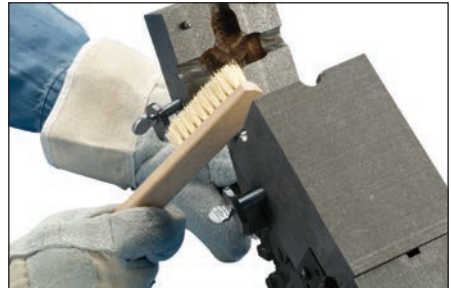
Fig. 24 – Los moldes de grafito Cadweld podrán ser utilizados en 50 conexiones aproximadamente. Utilice un paño de algodón suave o un cepillo de cerdas suaves (nVent ERICO artículo T394) para limpiar el interior de la cavidad del molde y la cubierta.
