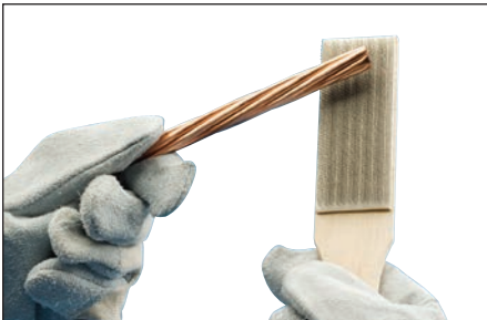
Fig. 12 – A continuación, utilice un cepillo metálico para preparar la superficie de los conductores (cepillo nVent ERICO T-313 o T-314). Raspe la superficie exterior para eliminar la suciedad y la oxidación. Notará un ligero cambio de color.
