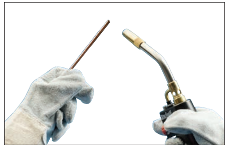
Fig. 4 – Los conductores deben estar limpios y secos antes de realizar la conexión. Use un soplete para secar los conductores de alambre y eliminar los residuos de limpieza restantes, disolvente o agua antes de realizar la conexión Cadweld.
