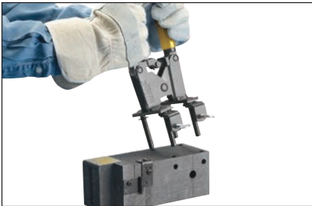
Fig. 6 – Deslice el mango en los orificios pretaladrados con la orientación adecuada para los tornillos mariposa.
