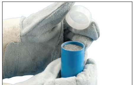
Fig. 20 – A continuación, tome el tubo de metal de aporte incluido en el paquete de Cadweld Exolon y retire la tapa sobre el crisol del molde.
