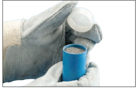
Fig. 19 – Retire la tapa sobre el crisol del molde.
