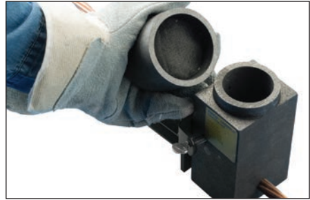
Fig. 27 – Retire las pinzas de cocodrilo de la espiga de encendido. Retire la cubierta de grafito del molde Cadweld Exolon.
