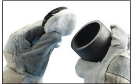
Fig. 14 – Cada paquete Exolon contiene 2 filtros para una conexión de baja emisión. Introduzca los filtros de cerámica blanca y de grafito negro en la cubierta del molde. (Los filtros deben cambiarse cada 4 conexiones).
