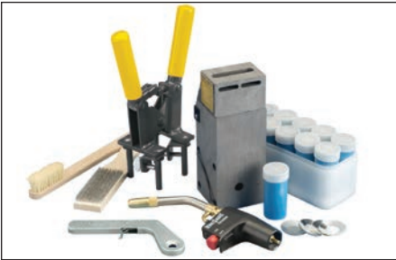
Fig. 2 – Reúna los materiales y equipos adecuados para el tipo de conexión que está realizando. El sistema típico Cadweld requiere un molde de grafito, mango, metal de aporte, cepillo de cerdas naturales para la limpieza del molde, cepillo metálico para la limpieza/preparación de los conductores, encendedor y soplete.
