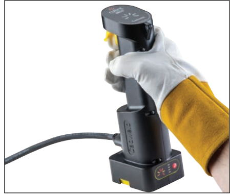
Fig. 13 – Usando la unidad de control, levante la tapa del gatillo y pulse el botón de encendido y manténgalo pulsado. Verá que las 6 luces en la parte superior de la unidad se iluminan mientras la unidad se está cargando. Después de que se encienda la sexta luz, la unidad enviará una carga a la tira de encendido, iniciando la reacción aluminotérmica Cadweld Plus.
