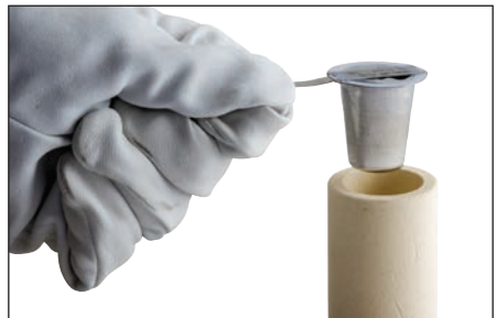
Fig. 9 – Coloque el crisol del metal de aporte en la parte superior del molde. Asegúrese de que la tira de encendido anide en el hueco del borde superior.
