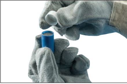
Fig. 10 – A continuación, tome el tubo de metal de aporte incluido en el paquete Cadweld One Shot y retire la tapa sobre el crisol.
