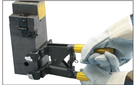
Fig. 8 – Cierre las empuñaduras para asegurar firmemente el molde. Compruebe si el molde tiene un sello adecuado.
