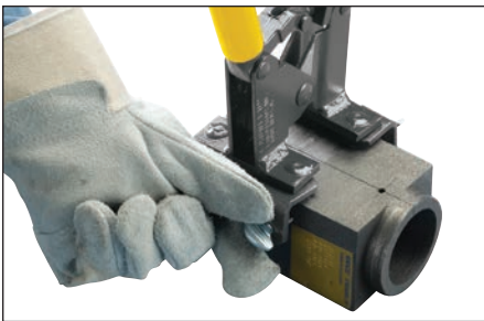
Fig. 7 – Apriete los tornillos mariposa del mango en el molde.
