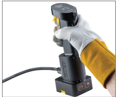
Fig. 20 – Usando la unidad de control, levante la tapa del gatillo y pulse el botón de encendido y manténgalo pulsado. Verá que las 6 luces en la parte superior de la unidad se encienden mientras la unidad se está cargando. Después de que se encienda la sexta luz, la unidad enviará una carga a la tira de encendido, iniciando la reacción aluminotérmica de Cadweld Plus.
