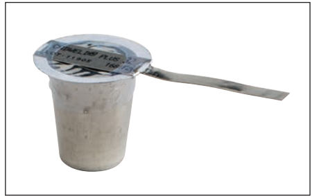
Fig. 8 – Inspeccione el crisol para asegurarse de que esté bien ajustado y de que la tira de encendido esté bien sujeta al encendedor.
