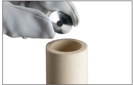
Fig. 8 – Coloque el disco en el Cadweld One Shot con el lado cóncavo hacia arriba.
