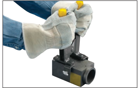
Fig. 9 – Si el molde no se ajusta correctamente, apriete o afloje el mango hasta que se ajuste.
