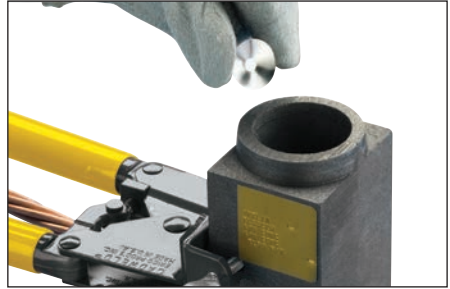
Fig. 18 – Introduzca el disco (con el lado cóncavo hacia arriba) en el molde. Sostenga el disco al lado del molde y deje que se deslice en su lugar.
