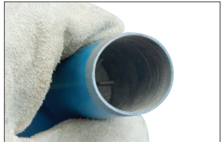
Fig. 21 – El fondo del tubo contiene material comprimido (material de ignición). Golpee suavemente el fondo del tubo un par de veces para aflojar este material.
