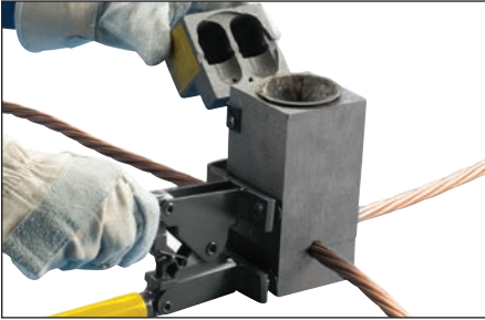
Afb. 21 – Verwijder de connector van de ontstekingsstrip. Open het deksel en verwijder de gebruikte Cadweld Plus-lascup uit de mal.
