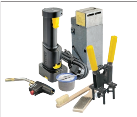
Afb. 2 – Bereid de juiste materialen en gereedschap voor om de las te kunnen maken. Het Cadweld Plus-systeem vereist een grafietmal, een malklem, een Cadweld Plus-laspoeder cup, een borstel (met natuurlijke haren) voor het reinigen van de mal, een staalborstel voor het reinigen/voorbereiden van geleiders, een onstekingsunit (Pluscu) en een propaanbrander.
