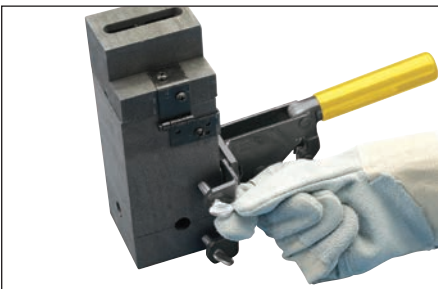
Afb. 7 – Draai de duimschroeven van de klem vast op de mal.
