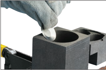
Afb. 16 – Plaats de stalen disk juist passend in diskzitting van de mal. Houd de stalen disk aan de zijkant van de mal vast en laat deze op zijn plaats schuiven.
