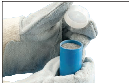
Afb. 20 – Neem vervolgens het laspoeder ,verpakt in een plastic buisje uit de Cadweld Exolon verpakking en verwijder het deksel.
