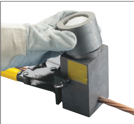
Afb. 22 – Plaats de Exolon-filter op de grafieten Cadweld mal, met de grotere kant naar beneden gericht.
