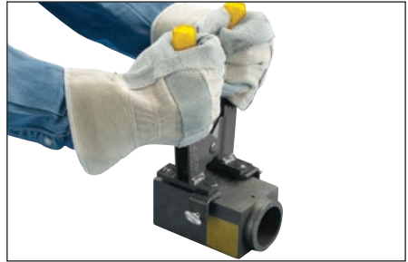
Afb. 9 – Als de mal niet goed afdicht, moet u de hendelklem afstellen.
