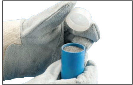
Afb. 19 – Verwijder deksel van de smeltkroes van de mal.
