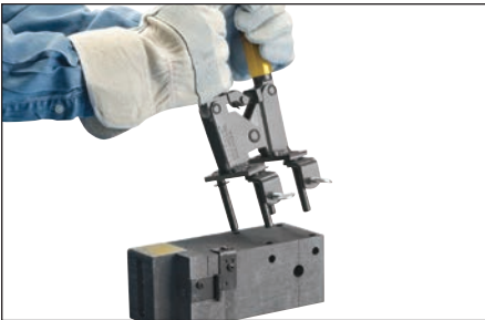
Afb. 6 – Schuif de hendelklem in de voorgeboorde gaten met de juiste oriëntatie voor de duimschroeven.
