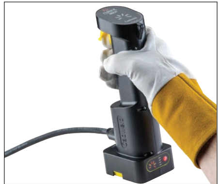
Afb. 20 – Til de trekerafdekking van de ontstekingsunit op, druk op de contactknop en houd deze ingedrukt. U ziet de 6 lampjes aan de bovenkant van het apparaat branden als het apparaat wordt opgeladen. Nadat het 6e lampje brandt, stuurt de unit een lading naar de ontstekingsstrip, waardoor de exothermische reactie van de Cadweld Plus wordt gestart.
