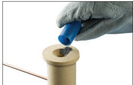
Afb. 14 – Giet het startpoeder op de Cadweld One Shot-deksel.
