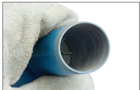
Afb. 21 – Onderin het laspoeder patroon zit gecompriemd materiaal (startmateriaal). Tik een paar keer op de onderkant van laspoederpatroon-buisje om dit materiaal los te maken.
