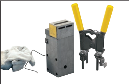
Afb. 5 – Verwijder vóór gebruik de kleine draadbeugel die wordt gebruikt om de mal tijdelijk bij elkaar te houden. Leg de beugel opzij.
