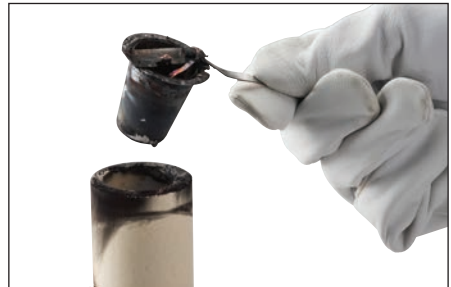
Afb. 14 – Verwijder de gebruikte Cadweld Plus metalen las-cup en gooi deze weg.
