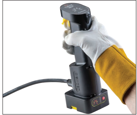
Afb. 13 – Til de trekker-lip van de ontsteker op, druk op de contactknop en houd deze ingedrukt. U ziet 6 lampjes oplichten bij volle lading. omhoog terwijl het apparaat wordt opgeladen. Nadat het 6e lampje brandt, stuurt de unit een lading naar de ontstekingsstrip, waardoor de exothermische reactie van de Cadweld Plus wordt gestart.
