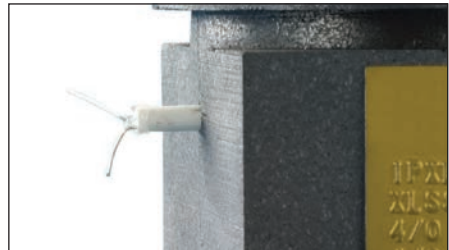
Afb. 23 – Neem vervolgens een ontstekingspen en plaats deze halverwege in het kleine gat aan de zijkant van de mal, met de luszijde naar het gat gericht. Spreid de draadjes van elkaar.
