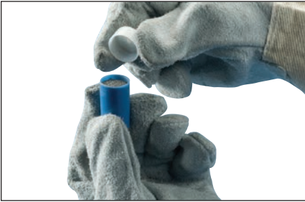
Afb. 10 – Neem vervolgens een patroon uit het Cadweld One Shot lasmateriaal pakket en verwijder het laspatroon- dopje.
