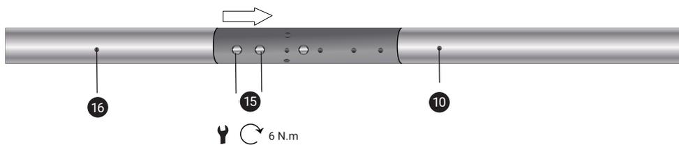
图 19 - 连接上部支撑杆和底部支撑杆
