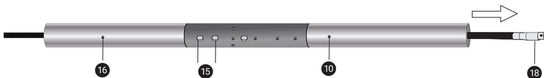
图 21 - 将内置导体穿过支撑杆
