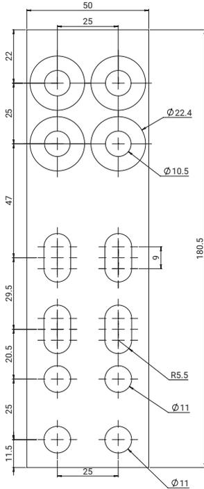
508114: Extensión Flexbus de 50 x 10 mm para conductor de 640 mm<sup>2</sup>, tipo 2
