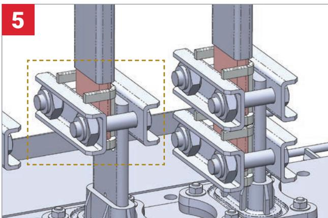
**5** **Conecte** el conductor Flexbus con la mordaza y la placa para barra de alta tensión (HCBC).
