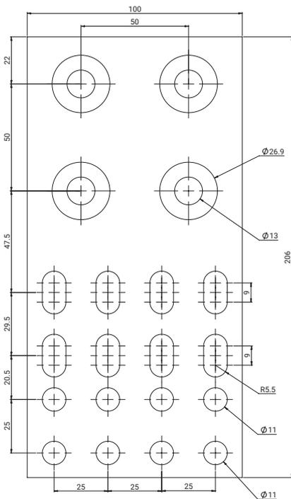
508117: Extensión Flexbus de 100 x 10 mm para conductor de 960, 1.280 y 1.810 mm<sup>2</sup>, tipo 2
