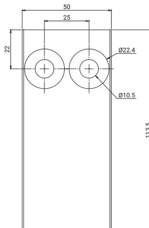
508112: Extensión Flexbus de 50 x 10 mm para conductor de 260, 360 y 545 mm<sup>2</sup>, tipo 3
