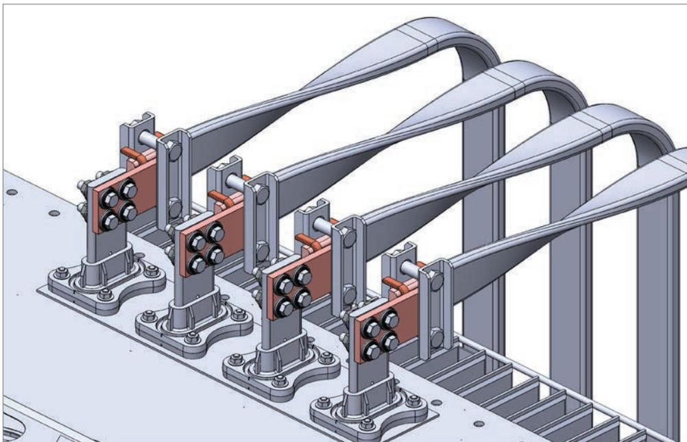
**Nota:** Si la entrada del conductor Flexbus es horizontal, se requiere un extensor de terminales entre el terminal de la fuente de alimentación y la mordaza y placa de HCBC, como se muestra en la ilustración.
