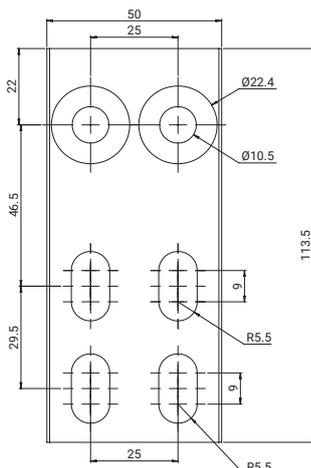
508111: Extensión Flexbus de 50 x 10 mm para conductor de 260, 360 y 545 mm<sup>2</sup>, tipo 2
