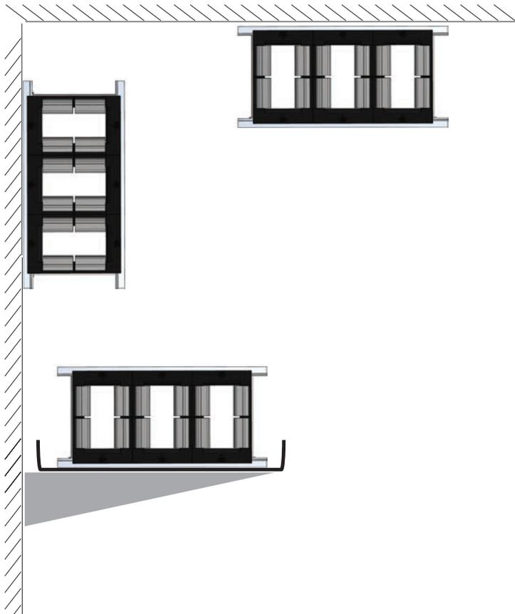
**Nota:** Para facilitar la instalación de los conductores Flexbus en las bandejas portacables, recomendamos utilizar un sistema en voladizo para tener un acceso fácil y directo durante la fase de instalación.
