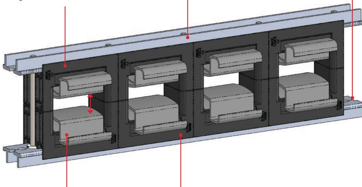
**Clip ajustable** para adaptar el soporte con diferentes grosores de conductores (posición abierta/cerrada).
