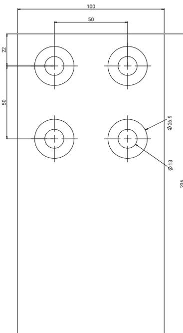
508118: Extensión Flexbus de 100 x 10 mm para conductor de 960, 1.280 y 1.810 mm<sup>2</sup>, tipo 3
