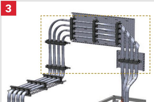
**3** **Instale** los conductores en los soportes y monte la parte superior de los soportes. Deje el excedente del conductor en la parte superior del transformador/de la fuente de alimentación.
