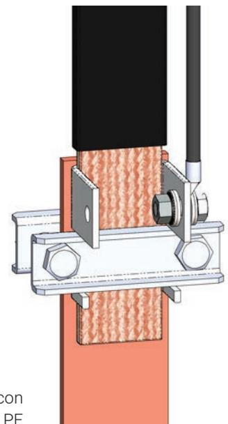
Placa HCBC con conexión PE
