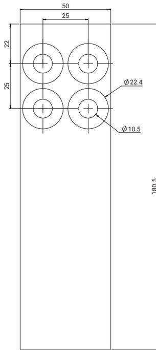
508115: Extensión Flexbus de 50 x 10 mm para conductor de 640 mm<sup>2</sup>, tipo 3
