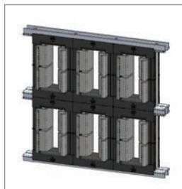
**Fuerte resistencia mecánica** y probado para cortocircuitos según IEC 61914 hasta  $67\text{ kA rms}$ – $147\text{ kA}$  pico.
