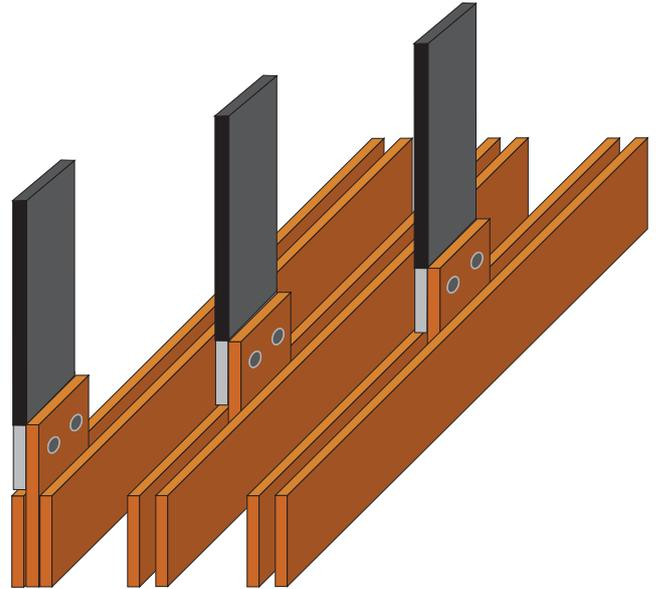
Dos barras del embarrado por fase y un conductor Flexbus conectado a través del extensor de terminales.
