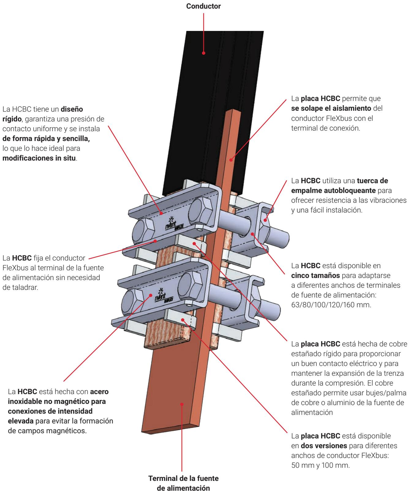
La HCBC tiene un **diseño rígido**, garantiza una presión de contacto uniforme y se instala **de forma rápida y sencilla**, lo que lo hace ideal para **modificaciones in situ**.
