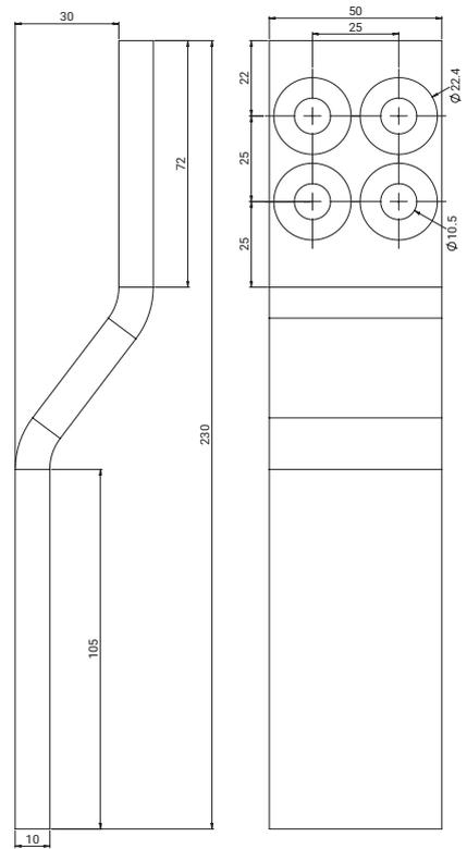
508116: Extensión Flexbus de 100 x 10 mm para conductor de 960, 1.280 y 1.810 mm<sup>2</sup>, tipo 1
