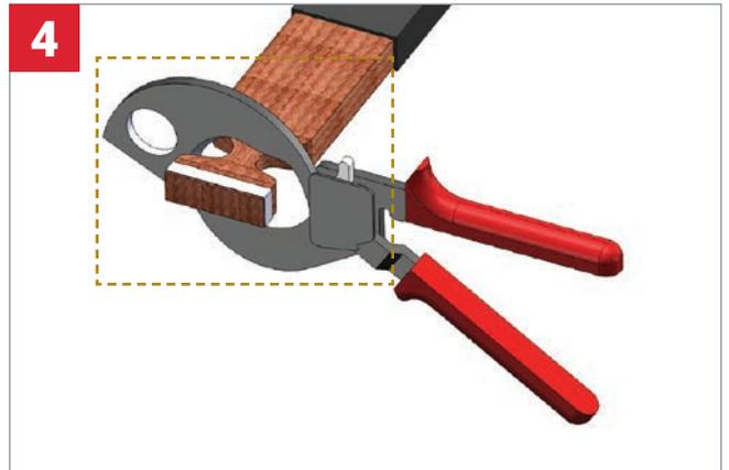
**4** **Pele** el aislamiento del conductor Flexbus. **Corte** el excedente del conductor Flexbus con tijeras o cizallas Flexbus.
