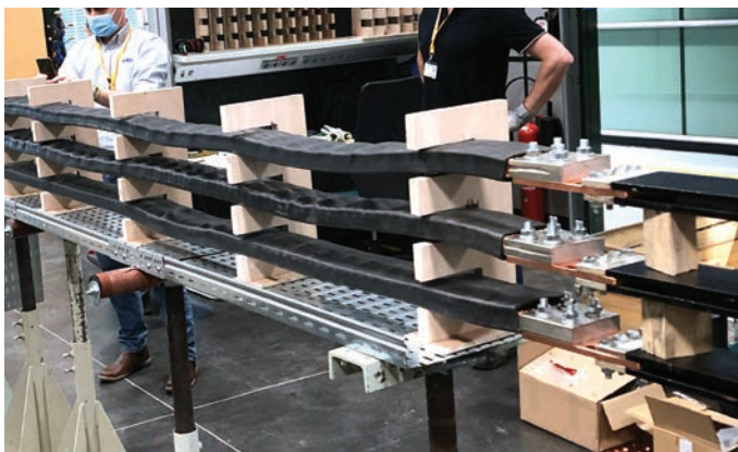
Essais d'échauffements de conducteurs Flexbus et capteurs de température positionnés le long du cheminement.
