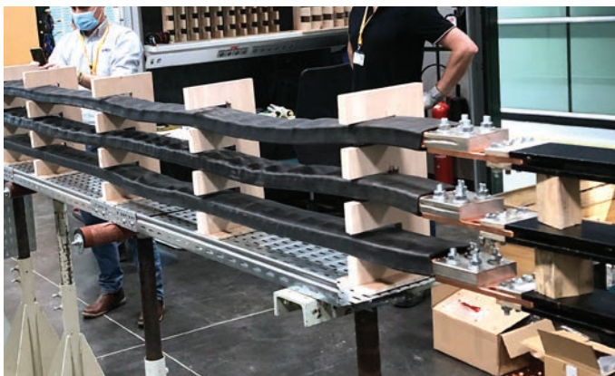
Foto's van de testsequentie voor temperatuurstijging en de sonde/temperatuursensor over de gehele installatie
