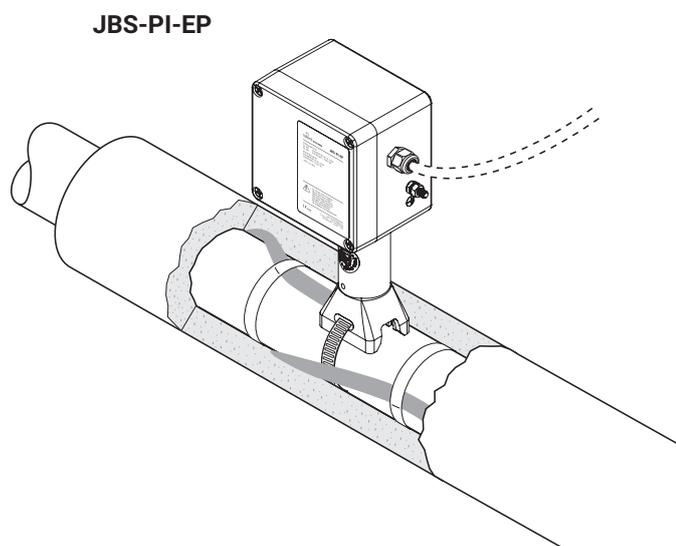
Le kit nVent RAYCHEM JBS-PI-EP est conçu pour raccorder directement des câbles chauffants en série nVent RAYCHEM XPI à usage industriel à une alimentation électrique sans utiliser de sorties froides et en présence de certaines restrictions de puissance et d'intensité.
