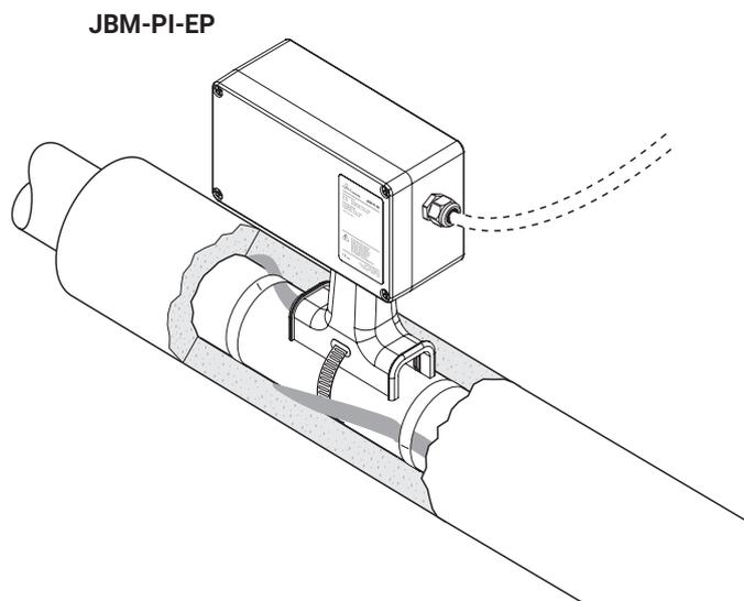
Le kit nVent RAYCHEM JBM-PI-EP est conçu pour raccorder directement des câbles chauffants en série nVent RAYCHEM XPI à usage industriel à une alimentation électrique sans utiliser de sorties froides et en présence de certaines restrictions de puissance et d'intensité.
