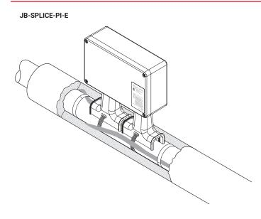
Le kit nVent RAYCHEM JB-SPLICE-PI-E est conçu pour raccorder directement des câbles chauffants en série nVent RAYCHEM XPI à usage industriel à une alimentation électrique sans utiliser de sorties froides et en présence de certaines restrictions de puissance et d'intensité.
