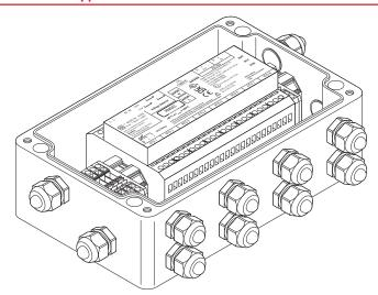
Модули дистанционного контроля электрообогрева nVent RAYCHEM RMM3 обеспечивают мониторинг температуры для контроллеров семейства nVent RAYCHEM Elexant и NGC. Каждый модуль RMM3 может принимать сигналы от 8 датчиков температуры nVent RAYCHEM PT 100, измеряющих температуры окружающей среды или трубопроводов в системе электрообогрева. Модули RMM3 связаны с nVent RAYCHEM терминалом пользовательского интерфейса для обеспечения централизованного контроля за температурой.
