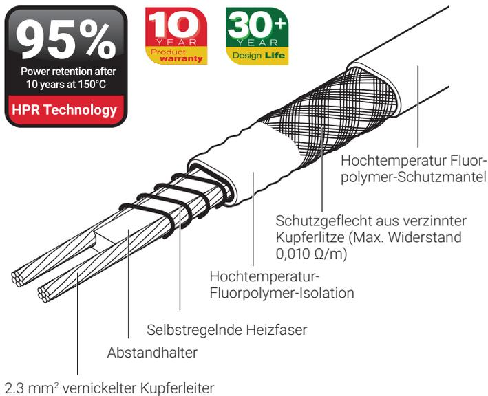
Das selbstregelnde Heizband nVent RAYCHEM XTVR ist für den Frostschutz oder das Halten von Prozesstemperaturen an selbstregelnden Rohrleitungen und Behältern ausgelegt, die eine hohe Leistungsabgabe und hohe Einsatztemperaturen erfordern.
