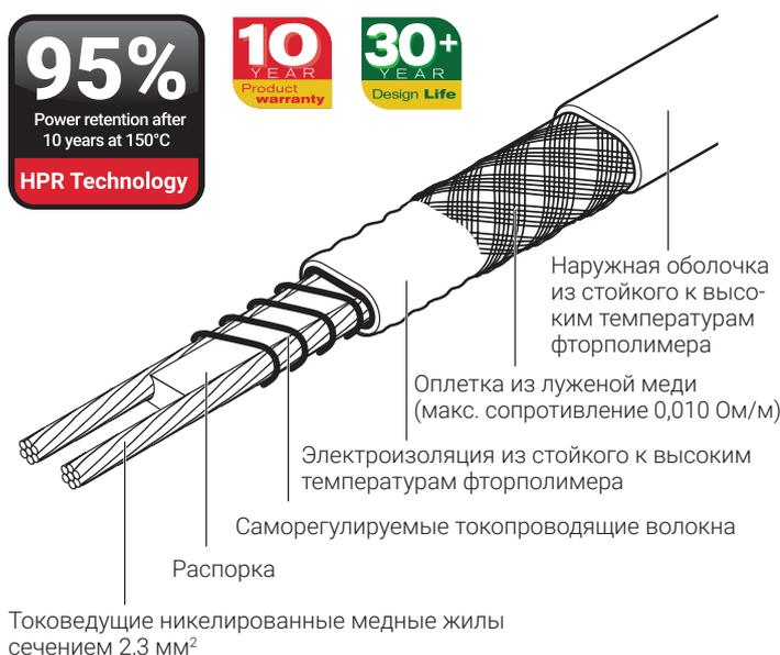
Саморегулируемый греющий кабель nVent RAYCHEM XTVR предназначен для защиты от замерзания или поддержания технологической температуры трубопроводов и емкостей, требующих высокой мощности и температуры воздействия.
