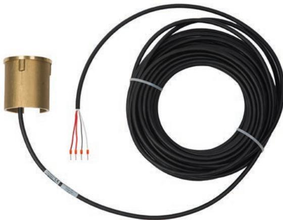
Bodenfühler zur kombinierten Messung von Temperatur und Feuchtigkeit in begehbaren oder befahrenen Außenbereichen. Robuste Ausführung aus Messing, vollständig eingekapselt.
