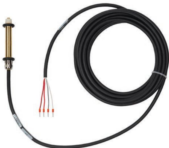
Capteur à tige E650C-R pour la mesure combinée de la température et de l'humidité dans les gouttières et les zones adjacentes, telles que les toits plats et les descentes, à utiliser avec l'Elexant 650c-Modbus. Capteur robuste en laiton, entièrement encapsulé. Conception extrêmement compacte avec sortie de câble axiale et boulon fileté pour la fixation en position.
