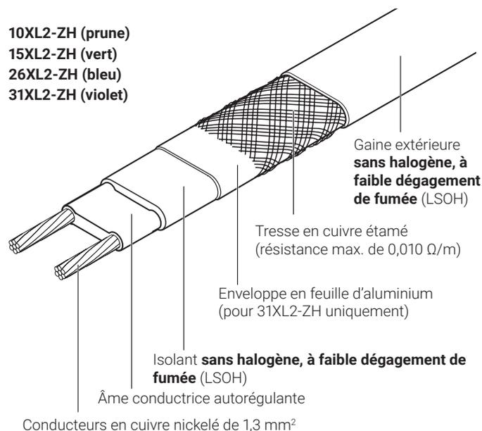
Le ruban chauffant nVent RAYCHEM XL-Trace assure la mise hors gel des tuyauteries dans les zones exposées à des températures négatives et garantit le maintien de l'écoulement des canalisations d'évacuation d'eaux usées.
