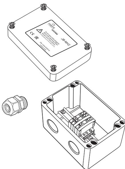
Распределительная коробка nVent RAYCHEM JB-NH2 представляет собой стандартную распределительную коробку с уплотнением силового кабеля для безопасных зон.
