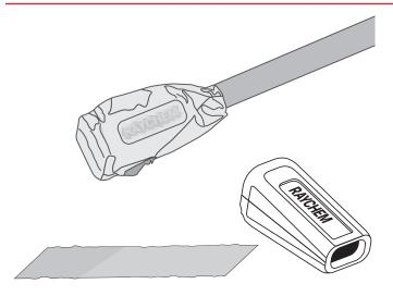
Концевая заделка nVent RAYCHEM E-02-AL
