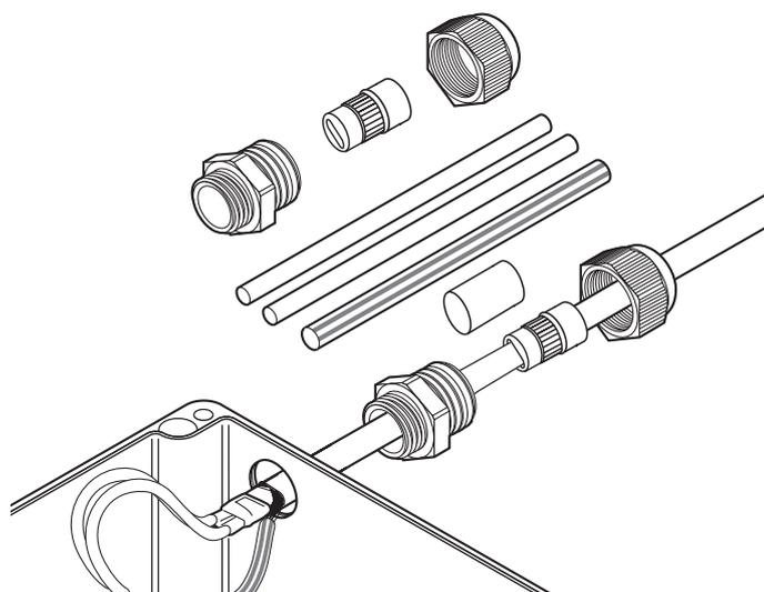
Подсоединительный комплект предназначен для заделки всех промышленных параллельных греющих кабелей nVent RAYCHEM BSA и BTV-CR в распределительной коробке с сохранением электроизоляции проводников и сердечника греющего кабеля.
