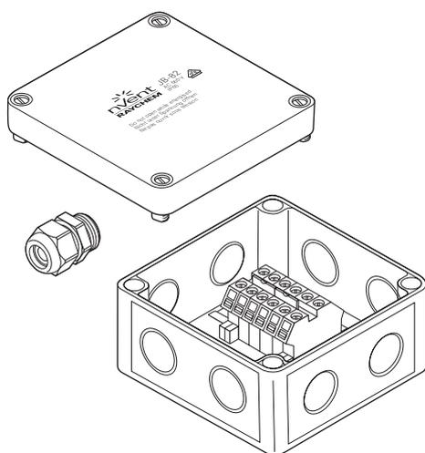
Стандартные соединительные коробки nVent RAYCHEM JB-82 из поликарбоната предназначены для использования в невзрывоопасных зонах.
