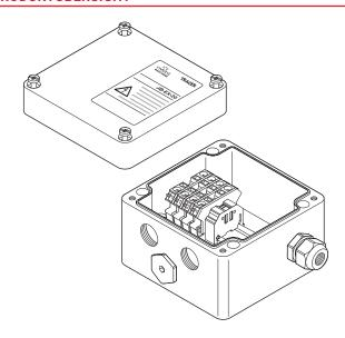
ATEX-zugelassener Anschlusskasten für den Einsatz im Ex-Bereich, geeignet für nVent RAYCHEM Heizkabel der Typen FMT/ FHT sowie PI- und MI-Heizkabel. Dieser Anschlusskasten kann zur Verbindung zwischen Zuleitungen, Heizkabeln und Kaltleitern verwendet werden. Entsprechend der Systemkonfiguration kann der Anschlusskasten sechs Heizkabel/Kaltleiter und ein Zuleitungskabel aufnehmen. Die nVent RAYCHEM M20-Anschlussgarnituren müssen entsprechend dem verwendeten Heizkabel getrennt bestellt werden.
