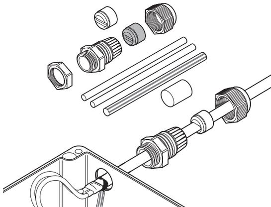
Diese Anschlussgarnitur ermöglicht den Anschluss der Heizbänder vom Typ nVent RAYCHEM BTV, QTVR, XTVR, KTV und VPL an einen der Anwendung entsprechenden Anschlusskasten.
