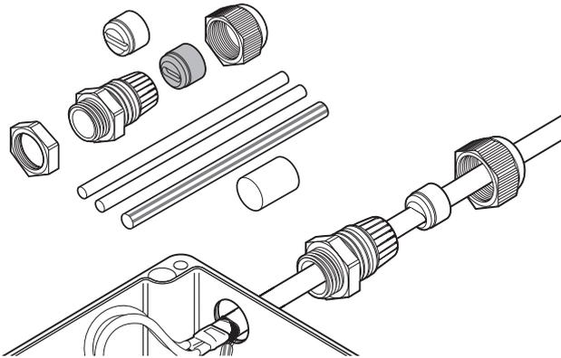
Ce kit de raccordement assure la liaison des rubans chauffants à circuit parallèle de type nVent RAYCHEM BTV, QTVR, XTV, KTV et VPL industriels à la boîte de raccordement tout en maintenant l'isolation électrique des conducteurs et de l'âme du ruban chauffant.
