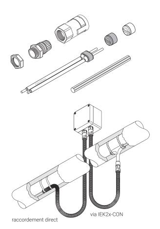
Ce kit de raccordement assure la liaison des rubans chauffants à circuit parallèle de type nVent RAYCHEM BTV, QTVR, XTV, KTV et VPL industriels à la boîte de raccordement tout en maintenant l'isolation électrique des conducteurs et de l'âme du ruban chauffant et en garantissant une connexion fiable et étanche à un système de flexible. Il est agréé pour les zones explosibles.
