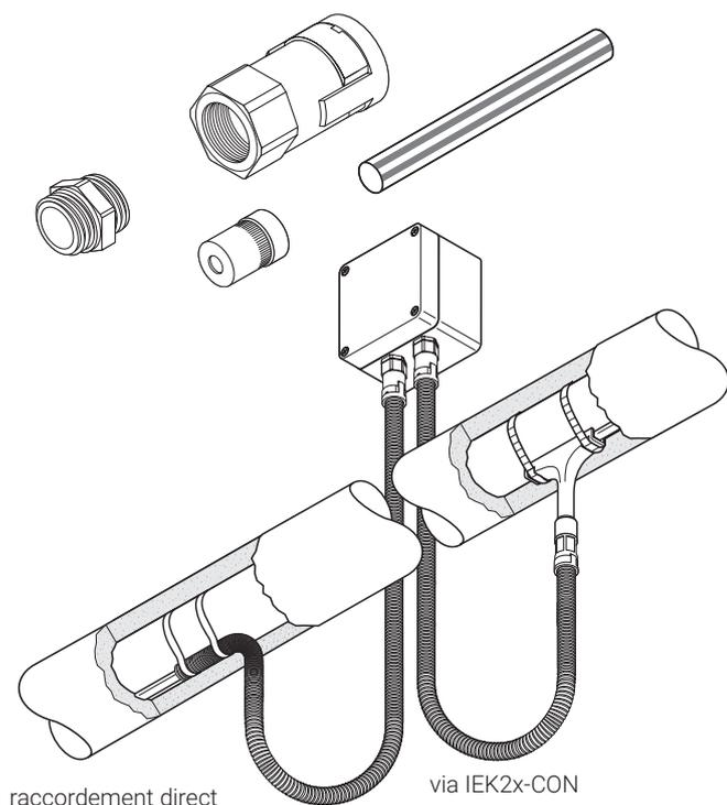
Ce kit permet de connecter à une boîte de raccordement les sorties froides ainsi que les câbles chauffants série à isolant polymère de la gamme nVent RAYCHEM XPI. Il assure également un raccordement étanche et fiable aux systèmes de flexibles.
