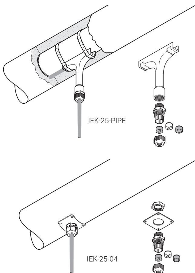
Diese Isolierungseinführungen schützen Heizbänder und -kabel überall dort vor mechanischer Beschädigung, wo sie durch Dämmung und Blechmantel geführt werden. Die Isolierungseinführungen (IEK) eignen sich für alle Heizbänder und -kabel sowie für Anschlusskabel. Sie sind für den Einsatz in Nicht-Ex- und Ex-Bereichen freigegeben.
