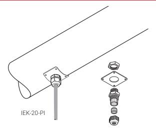
Diese Isolierungseinführungen schützen Heizbänder und -kabel überall dort vor mechanischer Beschädigung, wo sie durch Dämmung und Blechmantel geführt werden.
