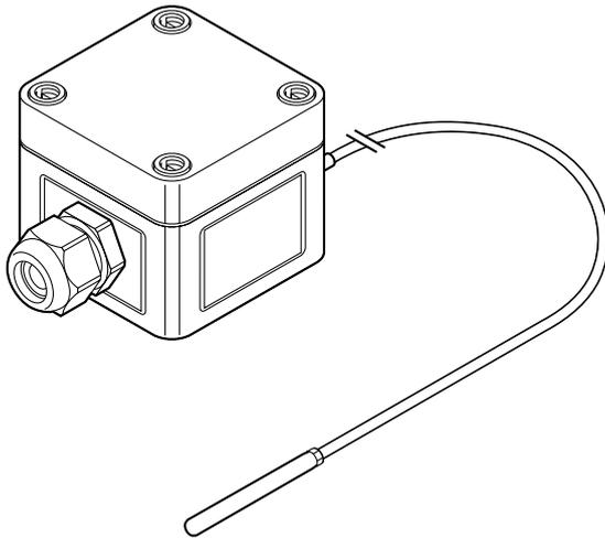
2-проводный датчик Pt 100 с соединительной коробкой из армированного стекловолокном поликарбоната предназначен для установки в нормальных зонах.
