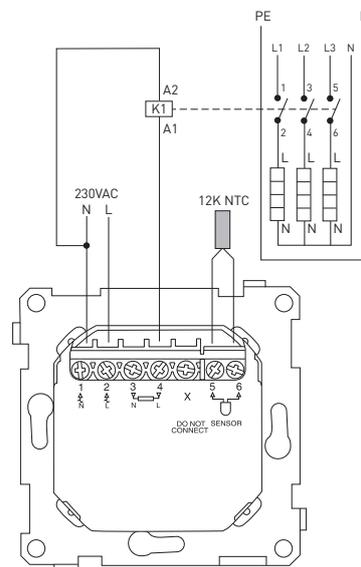
K1 : contacteur avec dispositif d'absorption
