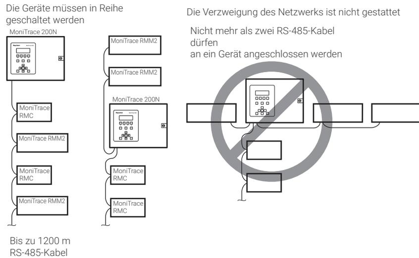
Abbildung 2.15. RS-485 Netzwerk, MoniTrace 200N, -RMM2 und -RMC
