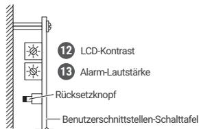
Abbildung 2.2. Anzeigenkontrast- und Alarm-Lautstärke-Einstellung
