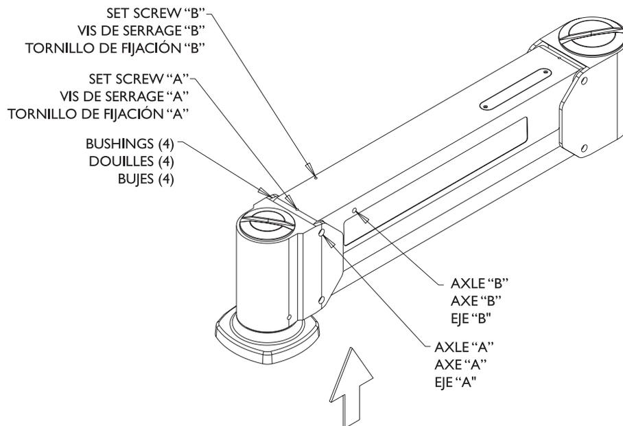
ARM MUST BE SUPPORTED BEFORE DISASSEMBLY
