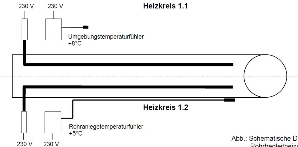
Abb.: Schematische Darstellung einer Rohrbegleitheizung nach VdS
