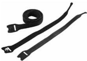
Sujeta un cable de manera segura en un organizador de cables y se abre fácilmente para dar mantenimiento al cable. La atadura de VELCRO® mide 0.5 pulg. (12.7 mm) de ancho. Disponible en longitudes de 8 y 12 pulg. (203 y 305 mm) tanto con sujetadores de tornillo o con estilo envolvente. El tornillo autorroscante M5 se utiliza en los racks de las series Net y ProLine.
