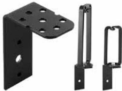
Se utiliza para montar el aro con forma de D (ordene por separado) en un organizador de cables ProLine, en un organizador vertical de cables de red con cintas para sujetar, en un soporte para aro con forma de D ProLine de adelante hacia atrás o en cinta. El aro con forma de D se traba en el orificio. De acero con una capa de pintura de poliéster pulverizada RAL 9005 de color negro. Incluye accesorios de montaje.
