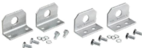
Utilisé pour assurer une meilleure répartition de la charge tout en soulevant deux ou trois armoires groupées avec une charge maximale de 1000 lb d'équipement et de câblage dans chaque armoire. Les angles se montent sur les coins supérieurs des blocs de coins du cadre de l'armoire et ne requièrent pas le retrait du couvercle supérieur pour l'installation. L'ensemble se compose de deux cornières et de quatre boulons et rondelles. Les angles sont en acier zingué clair de calibre 10.
