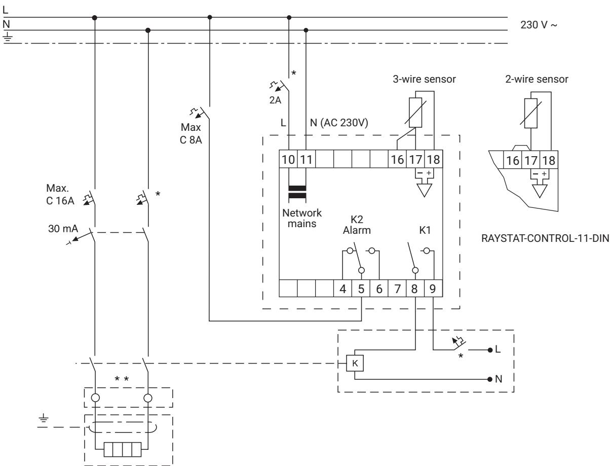
\* Örtliche Gegebenheiten, Normen und Vorschriften können die zwei- bis vierpolige Absicherung durch Leitungsschutzschalter/Fehlerstrom-Schutzschalter erforderlich machen.
