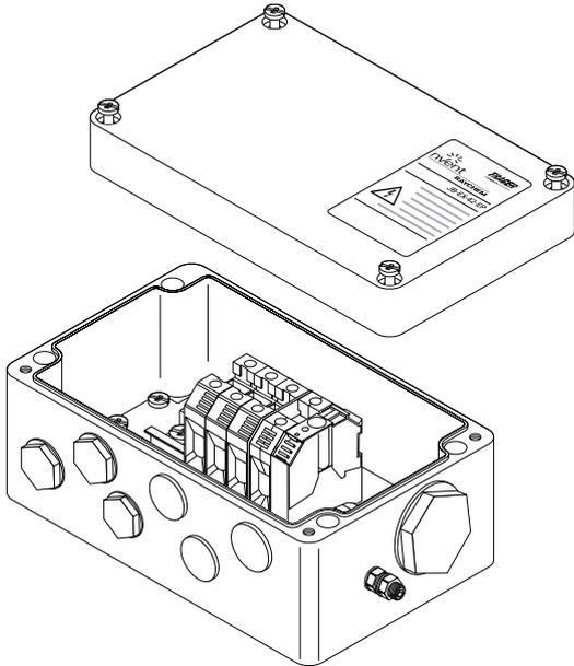
JB-EX-42-EP是带接地板的工业聚酯接线盒，用于危险区域。该接线盒使用M25金属连接套件或格兰能够连接电力电缆、伴热线和冷端线，通过接地板实现连接接地。
