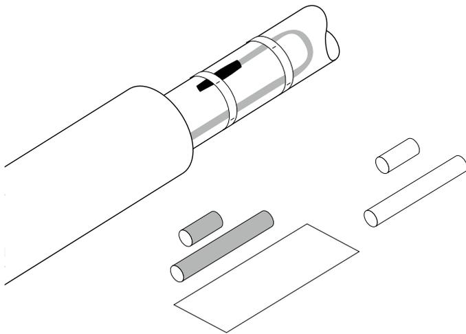
该系列尾端套件适用于RAYCHEM工业伴热线的尾端连接。
