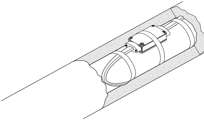
nVent RAYCHEM PMKG-LSC是用于nVent RAYCHEM BTV、CTV、QTVR、RTV自调控伴热线的两通接线盒，符合IEC标准。安装时固定于管道上，外面包有保温层，两通连接所用材料均可放于盒内。
