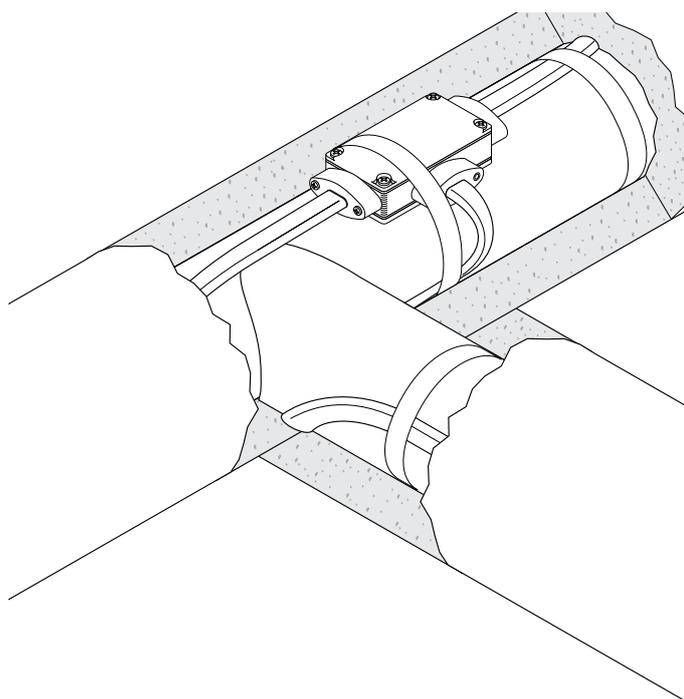
nVent RAYCHEM PMKG-LTC是用于nVent RAYCHEM BTV、CTV、QTVR、RTV自调控伴热线的三通接线盒，符合IEC标准。安装时固定于管道上，外面包有保温层，三通连接所用材料均可放于盒内。
