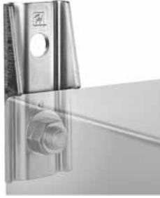
Los soportes de acero inoxidable tipo 304 pueden instalarse en campo. Los soportes mantienen la clasificación 4X. Incluye todos los componentes de montaje. Cuatro soportes por kit.
