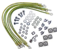
L'ensemble de mise à la terre permet de mettre à la terre un boîtier ProLine ou ProLine G2 selon les spécifications VDE. Comprend six fils de calibre 12 de 411 mm (16.19) de long avec terminaisons annulaires et accessoires de montage M6.
