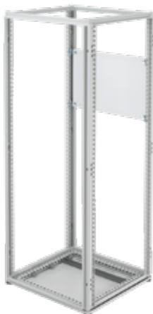
Les panneaux secondaires partiels sont en acier de calibre 12, ont des brides sur quatre côtés et sont peints en blanc. Les panneaux peuvent être positionnés verticalement par intervalles de 25 mm et peuvent également être positionnés à n'importe quelle profondeur par intervalles de 25 mm à l'aide des bandes à grille en option. Les panneaux secondaires conducteurs sont en acier galvanisé non peint. Toute la quincaillerie de montage nécessaire est fournie.
