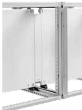
Fournit une surface de panneau continue dans les armoires à plusieurs baies. Les panneaux secondaires assemblés sont insérés entre des panneaux secondaires pleins de même hauteur. Le montage peut se faire par l'avant ou par l'arrière. Des orifices pour la mise à la terre et la quincaillerie de montage sont fournis. La finition est blanche. Les panneaux secondaires assemblés sont en acier galvanisé non peint.
