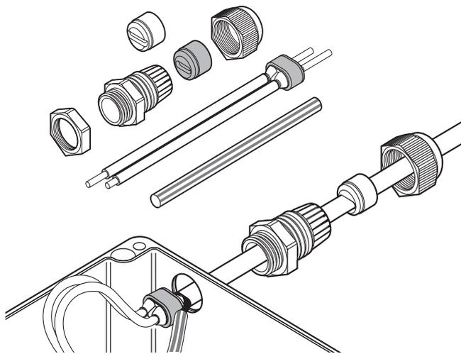
Diese Anschlussgarnitur ermöglicht den Anschluss der Heizbänder vom Typ nVent RAYCHEM BTV, QTVR, XTVR, KTV, HTV und VPL an einen der Anwendung entsprechenden Anschlusskasten. Die Anschlussgarnituren sind für den Einsatz in Ex-Bereichen freigegeben.
