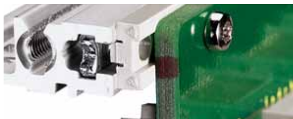
Modulschiene hinten zur Backplanemontage mit Isolierstreifen
