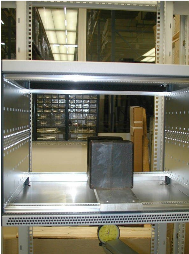
Bild10 Belastung des Gehäuses mit Normgewicht.
