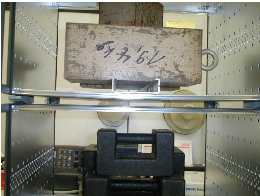
Bild5 Versuch 2a: Durchbiegung bei 60 kg Belastung.
