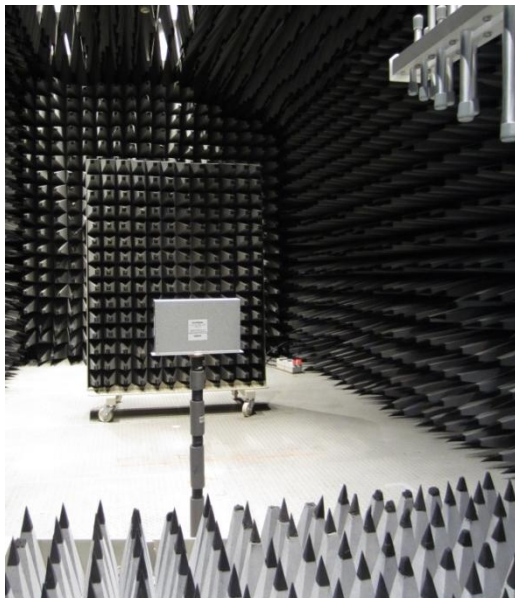
Abbildung 5: Aufbau im Frequenzbereich 30 MHz - 1 GHz
