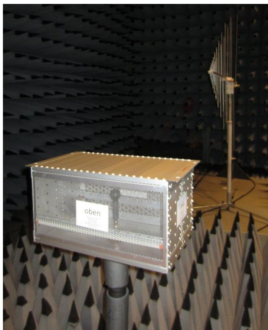
Abbildung 5: Aufbau im Frequenzbereich 30 MHz - 1 GHz
