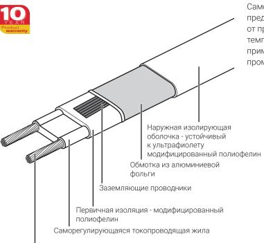
Саморегулирующийся греющий кабель nVent RAYCHEM BSA предназначен для защиты промышленных трубопроводов от промерзания без очистки паром при умеренной температуре технологического процесса. Кабель можно применять в составе внутренних и наружных установок промышленных безопасных зон.
