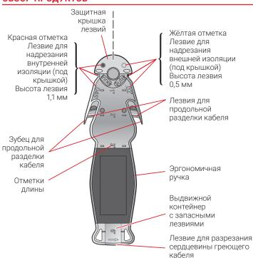
nVent RAYCHEM Stripping-Tool-SR-Cable — инструмент для разделки саморегулируемых греющих кабелей nVent RAYCHEM BTV-CR, BTV-CT, QTVR-CT, XTVR-CT, HTV-CT, HWAT, XL-Trace, IceStop и RaySol. Этот инструмент предназначен для обеспечения более быстрой, безопасной и надёжной разделки кабелей.
